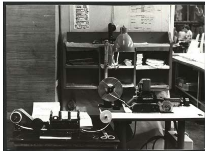
Рис.4. Техническое оборудование на швейной фабрике «Красная звезда» - станок для маркировки контрольных талонов. КМК КП-18965-17
