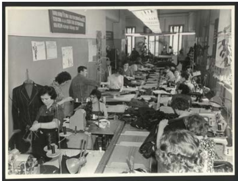
Рис.3. Двухленточный конвейер на пошиве изделий высшего качества на швейной фабрике «Красная звезда». КМК КП-17502-6.
