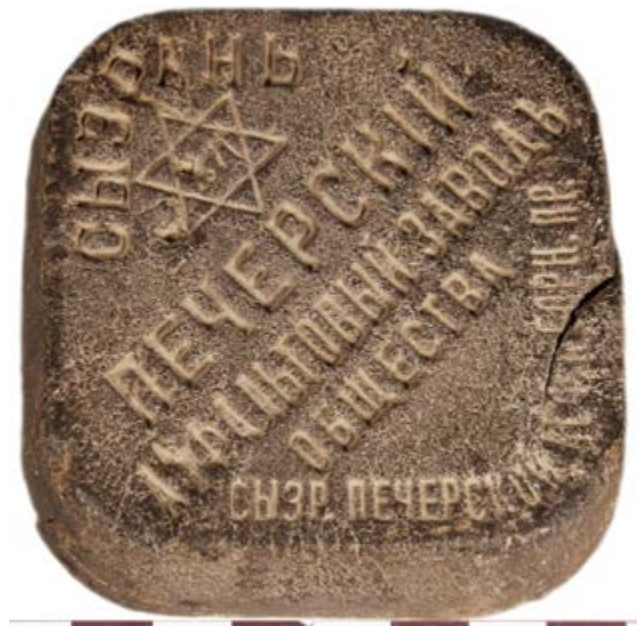
Рис.1. Образец плиты асфальтовой мастики, производимой на Печерском асфальтовом заводе с 1871 г. Из фондов СОИКМ им. П.В. Алабина.
